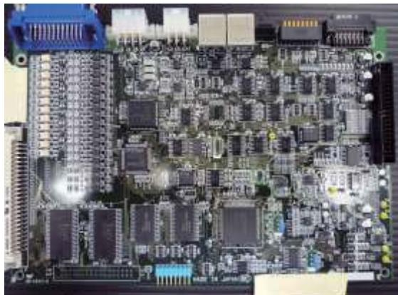
プリント基板(多層)に電子部品(チップ部品、異形部品)を実装した製品です。
