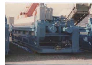
トンネル工事用脱水装置
