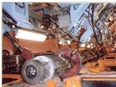
**型枠付属品外し装置**
