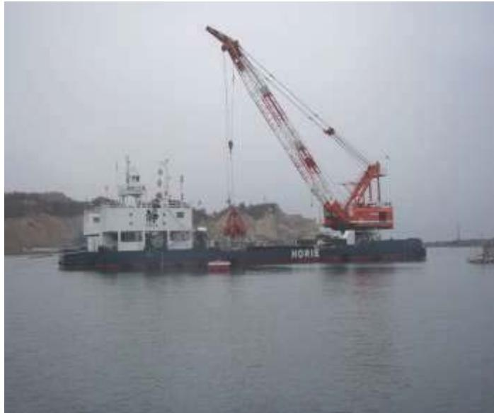
全旋回式 155t 吊起重機船兼グラブ浚渫船
