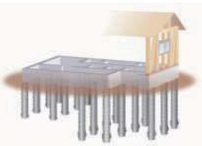
使用する材料は採石のみ。一部鉄筋コンクリートの建物にも利用可能。
